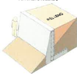
MURO DE CONTENCIÓN CONCRETO ARMADO
