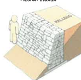
MURO DE CONTENCIÓN PIEDRA PIRCADA
